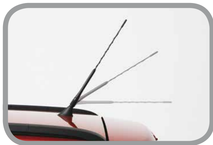
アンテナアングルスペーサー ルーフアンテナの角度調整を可能にし、立体駐車場などの進入の際に便利です。
