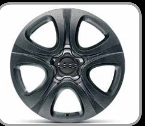
18インチ アロイホイール グラニュレート[粉体塗装仕上げ] サイズ7.0J×18。適合タイヤサイズ225/45R18。センター キャップは標準装備のものを使用する事が可能ですが、ブラック [商品番号:735626311]の使用を推奨。
