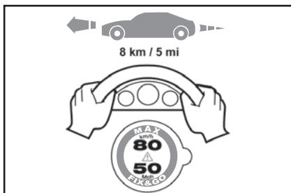
3 制限速度が表示されたステッカーを取り外し、明らかに視認できる位置に貼付します。
