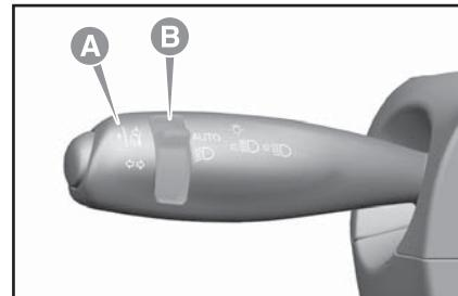
左側レバーで車外ライトの多くの機能を操作できます。
