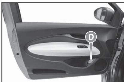
リモコンキー や ウエアラブルキー または 車両の 12V バッテリー の 電圧 が 低下 した とき など、リモコンキー や ウエアラブルキー が 作動 し ない とき は、フロントドア に ある 緊急レバー  $\text{D}$  を 引く こと で 車内 か ら ドア を 開く こ と が でき ます。
