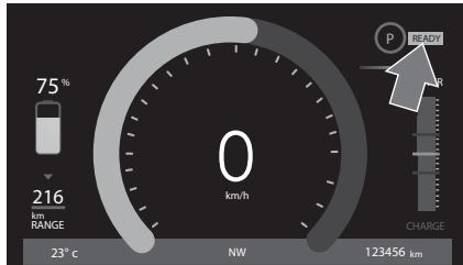
始動操作が完了すると、確認音が鳴り、メーターパネルにREADY表示灯が表示されて、車両の電気駆動システムが始動したことと示します。READY表示灯が表示されると、車両は発進する準備ができています。
