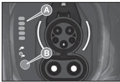
充電作動中は、バッテリーの充電レベルに応じて、LED A が緑色で点灯/点滅します。
