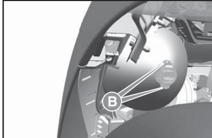
2. フィン **B** を押して、バルブホルダーを取り外します。
