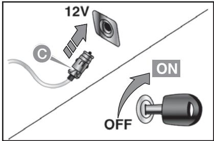
6. 12V電源ソケットに電源プラグ④を差し込み、イグニッションをRUNにします。
