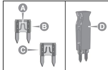
**B**が正常なヒューズで、**C**がフィラメント部分が損傷したヒューズです。
