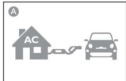
アースされた家庭用電源コンセントから充電できます。この種類のコンセントは、交流電流で充電する際に使用します。「モード2」充電ケーブルは、「IEC 61851、IEC 62752」および「SAE J1772」規格に準拠しています。
