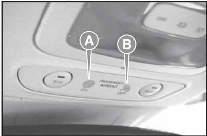
警告灯**A**は、助手席フロントエアバッグ／助手席側サイドバッグ＜装備車＞が作動可能な状態であることを示しています。この場合は、助手席に後ろ向きのチャイルドシートを装着することは禁止されています。
