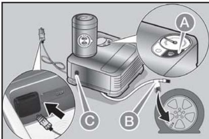
エアポンプ底部に収納されている（黒色）ホースを取り出し、ホース先端のコネクターAをタイヤのバルブに接続します。
