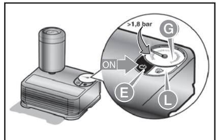
5. エアポンプのスイッチ(E)がOFFの状態（押し込まれていない状態）であることを確認します。
