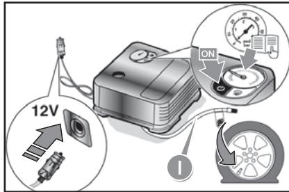
12.黒色のホース①をタイヤバルブに接続し、再度エアポンプを作動させてタイヤに空気を入れます。
