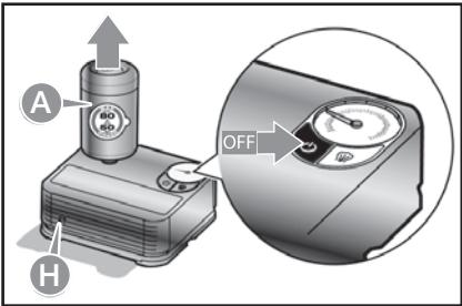
9.エアポンプを作動させてから約15分以内に、空気圧が1.8bar (26psi) 以上にならないときは、エアポンプを停止し、タイヤバルブからホースを外して、電源ソケットから電源プラグを外します。さらに、エアポンプ⑥からシーラント剤ボトル⑦を取り外します。
